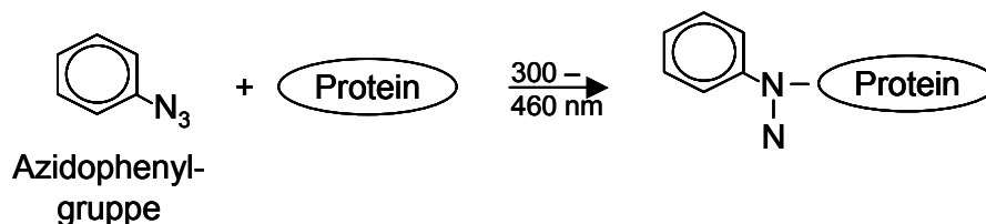
Abb. 3-30: Reaktionsmechanismen der heterobifunktionellen Quervernetzer. (A) Reaktionsschema der N-Hydroxysuccinimid-Ester (NHS-Ester) mit primären Aminen. Bei geeigneten Reaktionsbedingungen ( \text{pH} > 7 ) bilden NHS-Ester mit primären Aminen eine Amidbindung unter Abspaltung von N-Hydroxysuccinimid. (B) Fotolysereaktion der Azidophenylgruppe. Die fotoreaktive Azidophenylgruppe ist chemisch inert. Bei Belichtung ( \lambda 300 – 460 nm) entsteht jedoch ein Arylnitren, das unspezifisch kovalente Bindungen eingeht.
