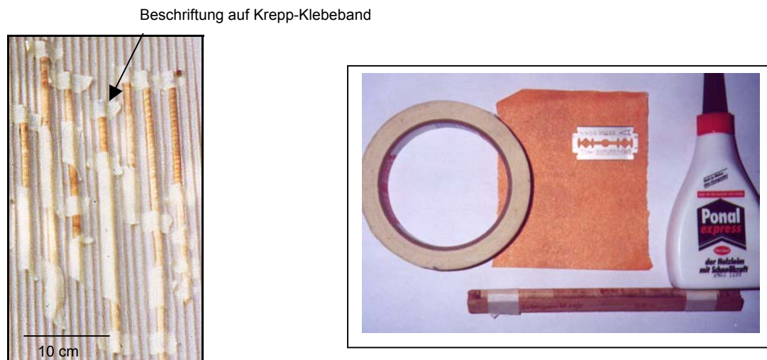
Abb. 17: Auf Wellpappe eingeklebte Kerne (links) und Utensilien für die Kernpräparation (rechts).
