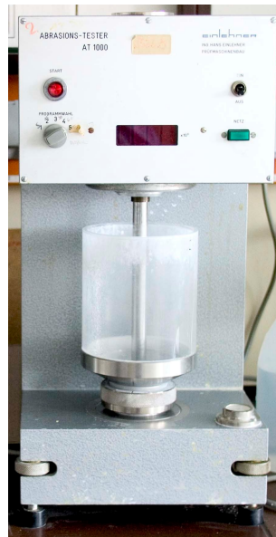
Abbildung 3.1.: AT1000 der Firma Einlehner zur Bestimmung der Abrasion von Pigmenten
