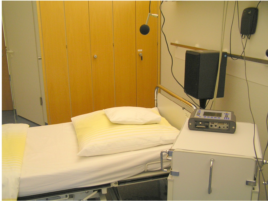
Abbildung 2 Versuchsaufbau: das Mikrophon hängt im Abstand von 50 cm über dem Gesicht des auf dem Rücken liegenden Probanden, der Lautsprecher steht im Abstand von 50 cm am Kopfende des Bettes
