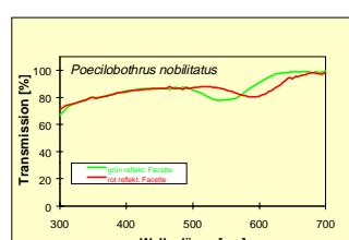
Die Augen von *Poecilobothrus nobilitatus* (Diptera: Dolichopodidae) weisen im zentralen Augenteil alternierende Längsschichten von roten und grünen Facetten auf. Entsprechend ist die Transmission der Cornealinsen im roten oder grünen Wellenlängenbereich reduziert.
