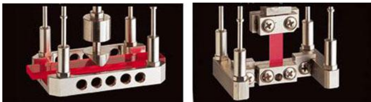
Abb. 10: Verschiedene Probenlagerung für Druck und Zug [NETZSCH Gerätebau 2009]
