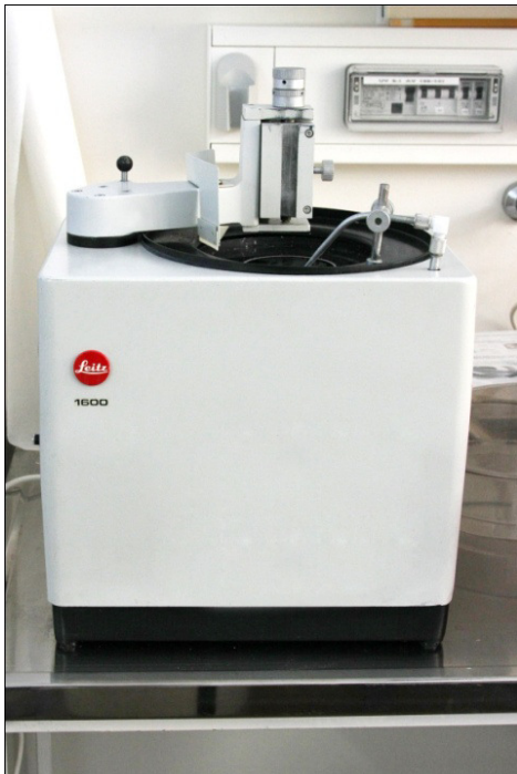
Abbildung 5: Das Sägemikrotom zum Schneiden der Zahnstücke
