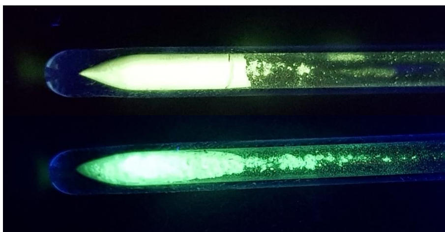
Abbildung 3.3-5 Lumineszenz der Verbindungen 9 (oben, 254 nm) und 10 (unten, 366 nm) bei Anregung mit UV-Licht der angegebenen Wellenlänge bei Raumtemperatur.
