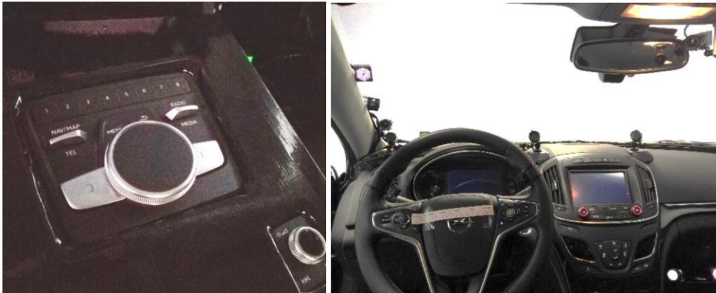
Abbildung 21: Aufbau des Fahrersimulators mit Audi Drehdrücksteller (links) und Fahrerbeobachtungssystem (rechts) (Hinterleitner et al., 2018)
