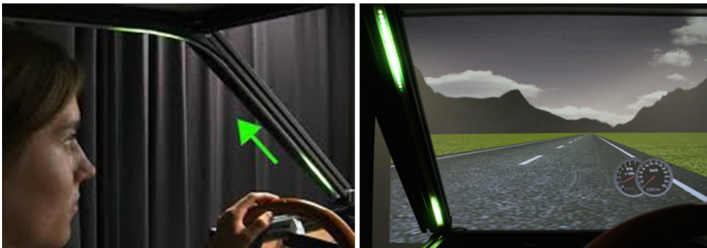
Abbildung 13: Verortung der LED-Streifen zur Beeinflussung der Fahrgeschwindigkeiten im Projekt ChaseLight (Meschtscherjakov et al., 2015)
