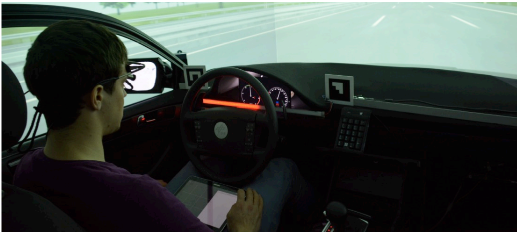
Abbildung 15: Vermittlung von Kontextinformationen im Rahmen von Take-Over-Requests durch Lichteffekte (Borojeni et al., 2016)
