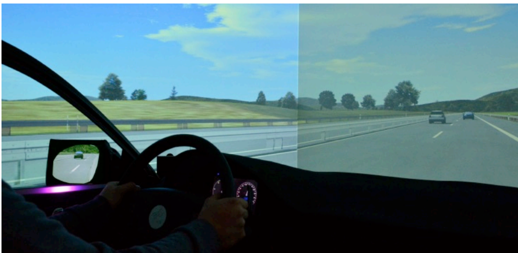
Abbildung 14: Lichteffekt zur Unterstützung bei der Entscheidung über einen Fahrspurwechsel (Löcken et al., 2015)
