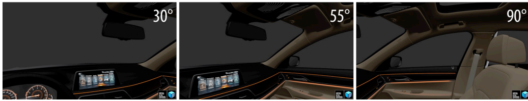
Abbildung 4: verändertes Sichtfeld durch vertikale Rotation des Kopfes um 30°, 55° und 90° (basierend auf internem Arbeitsmaterial der BMW AG).
