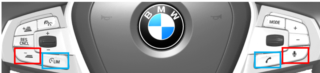
Abbildung 70: Belegung der Lenkradtasten für die Validierungsstudie. Rot markiert: Steuerung CTT; linke blau markierte Taste: Auffahrwarnung erkannt; rechte blau markierte Taste: Eingehender Anruf erkannt; beide blauen Tasten: keine Funktion erkannt.
