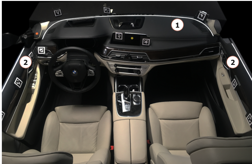
Abbildung 36: Sitzkiste mit LED-Streifen auf der Instrumententafel (1) sowie in beiden Türen (2)
