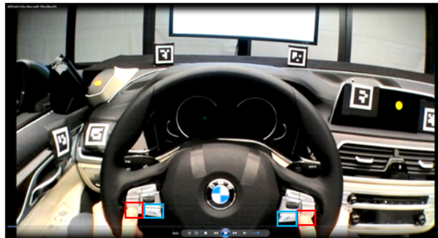
Abbildung 38: Lenkradtastenbelegung: rot-markiert = Navigation zwischen den Screens, Steuerung CTT; blau-markiert = Ausfüllen von Fragebögen, Reaktionszeitmessung.
