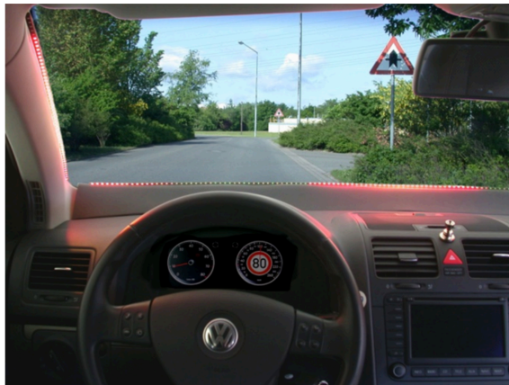
Abbildung 17: Darstellung der als „unscharfe Warnung“ bezeichneten LED-Anzeige in der Scheibenwurzel (Utesch, 2014, S. 17)
