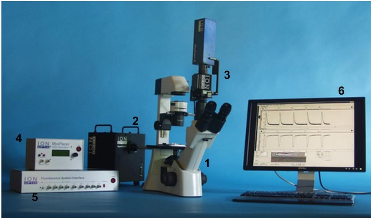
**Abbildung 2.18:** Beispielhafte Darstellung eines Epifluoreszenzsetups von IonOptix mit Mikroskop (1), Hyperswitch (2), Myozyten-Kamera und Photomultiplier (3), Myopacer (4), Fluoreszenz System Interface (5) und Computerprogramm Ion Wizard mit  $\text{Ca}^{2+}$ -Transienten und Sarkomerlängerverkürzung (6). Abbildung modifiziert nach <https://www.ionoptix.com/products/systems/>, © IonOptix Stand 18.08.2021
