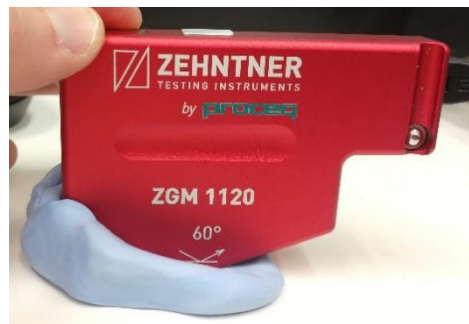
Abbildung 15. Glanzmessung mit der Puttyfixation für Prüfkörper und Sensor
