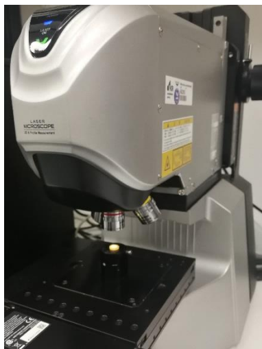
Abbildung 16. Oberflächenrauheitsmessung mit dem Keyence VK-X 100 Series Laser Mikroskop
