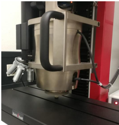
Abbildung 17. Härtemessung mit dem Gerät Zwick Roell Z.25
