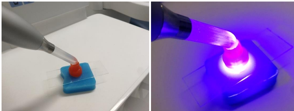
Abbildung 12. Polymerisationsvorgang mit dem aufgedrückten, erwärmten Objektträger
