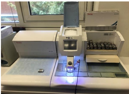
Abbildung 10: Paraffin-Ausgießstation "HistoStar" (Thermo Fisher Scientific)
