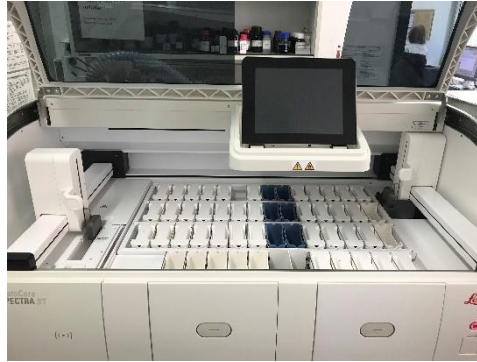
Abbildung 13: Histologie-Färbegerät "HistoCore SPECTRA ST" (Leica)
