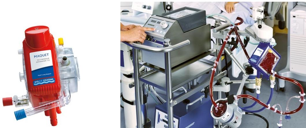
Abbildung 4: Linkes Bild: HLS Set Advanced (Cardiohelp) (50), rechtes Bild PLS-System (51) von Maquet/Getinge, beide mit Rotaflow-Zentrifugalpumpe. Im linken Bild sieht man das durchsichtige Gehäuse der Pumpe direkt auf dem roten Oxygenator und den zuführenden Schenkel mit einer blauen Kappe. Das rechte Bild zeigt ein blutgefülltes System mit Schlauchsystem, Pumpe und Oxygenator in blauer Hülle.
