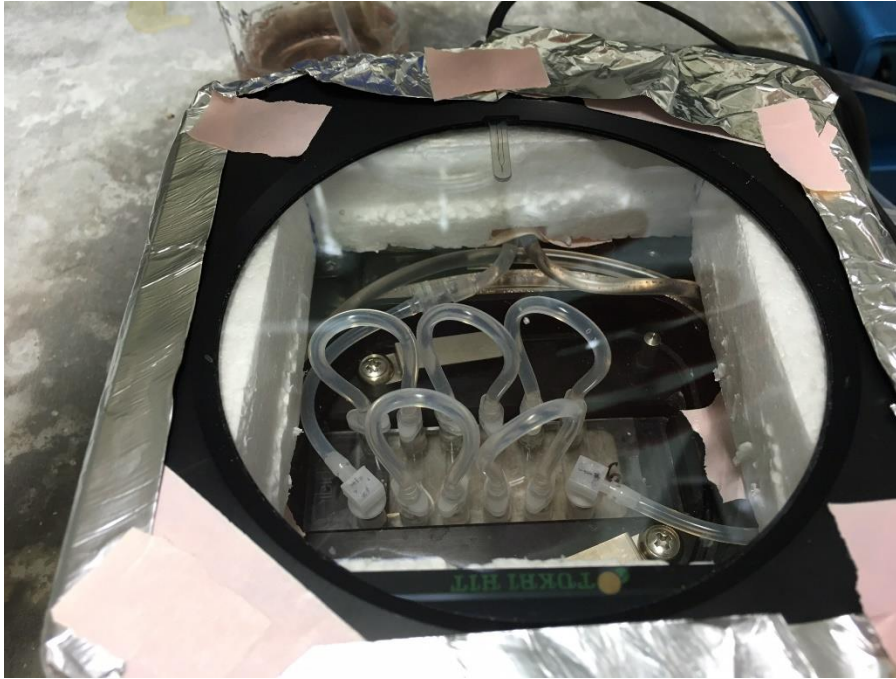
Abbildung 6: \mu -Slide VI 0.5 Glass Bottom als „serial connection“ in der umgebauten Klimakammer
