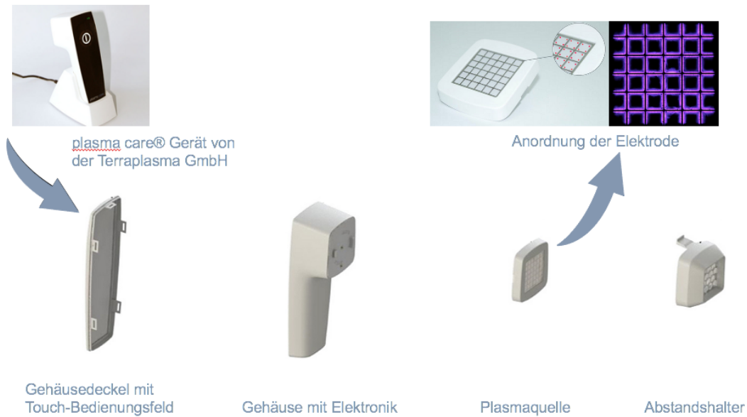
Abbildung 2: Aufbau des plasma care ® Geräts von Terraplasma; adaptiert an [77]
