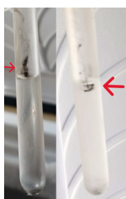
Abbildung 12: Schlenkgefäß mit dem Löslichkeitsversuch des Festkörpers mit der nominalen Zusammensetzung CsTl aus der großen Ampulle mit schwarzen Streifen an der Glaswand über dem Flüssigkeitsspiegel nach ca. einem Jahr Lagerung bei 233 K.
