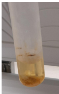
Abbildung 37: Gelb-orange Lösung und braune Streifen an der Flüssigkeitsgrenze des Löslichkeitsversuches des Ansatzes mit der nominellen Zusammensetzung \text{K}_2\text{RbTl}_3 nach einem Jahr bei 233 K.
