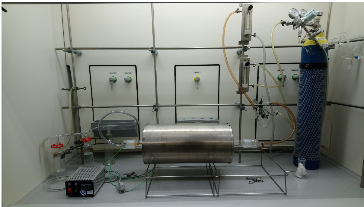
Abbildung 3.1 Abzug mit Syntheseaufbau zum Arbeiten unter dynamischer Ammoniak-/Wasserstoffatmosphäre
