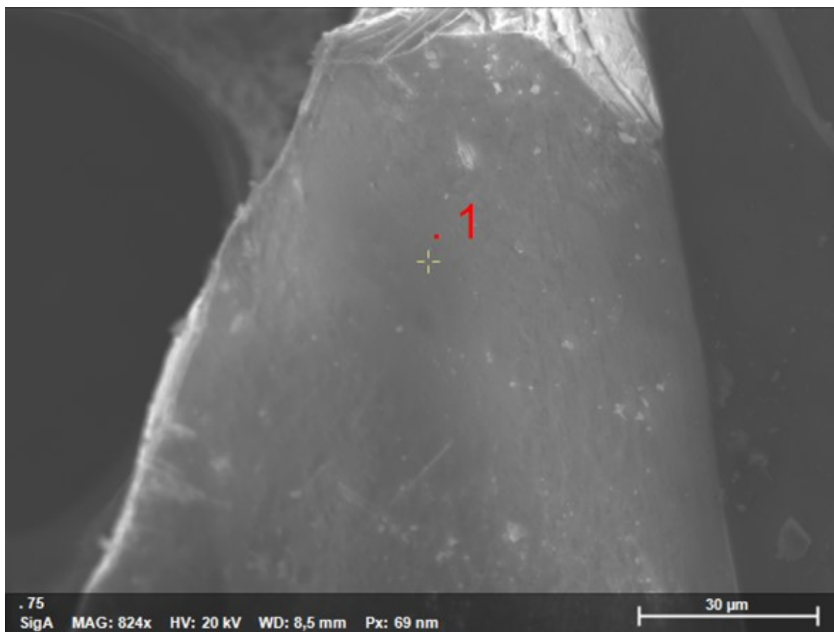
Abbildung 5.32 Rasterelektronenmikroskopische Aufnahme eines Kristalls von \text{Li}_3\text{InAs}_2 , aufgenommen mit 20 kV. rot markiert: ein Messpunkt auf der Kristalloberfläche.
