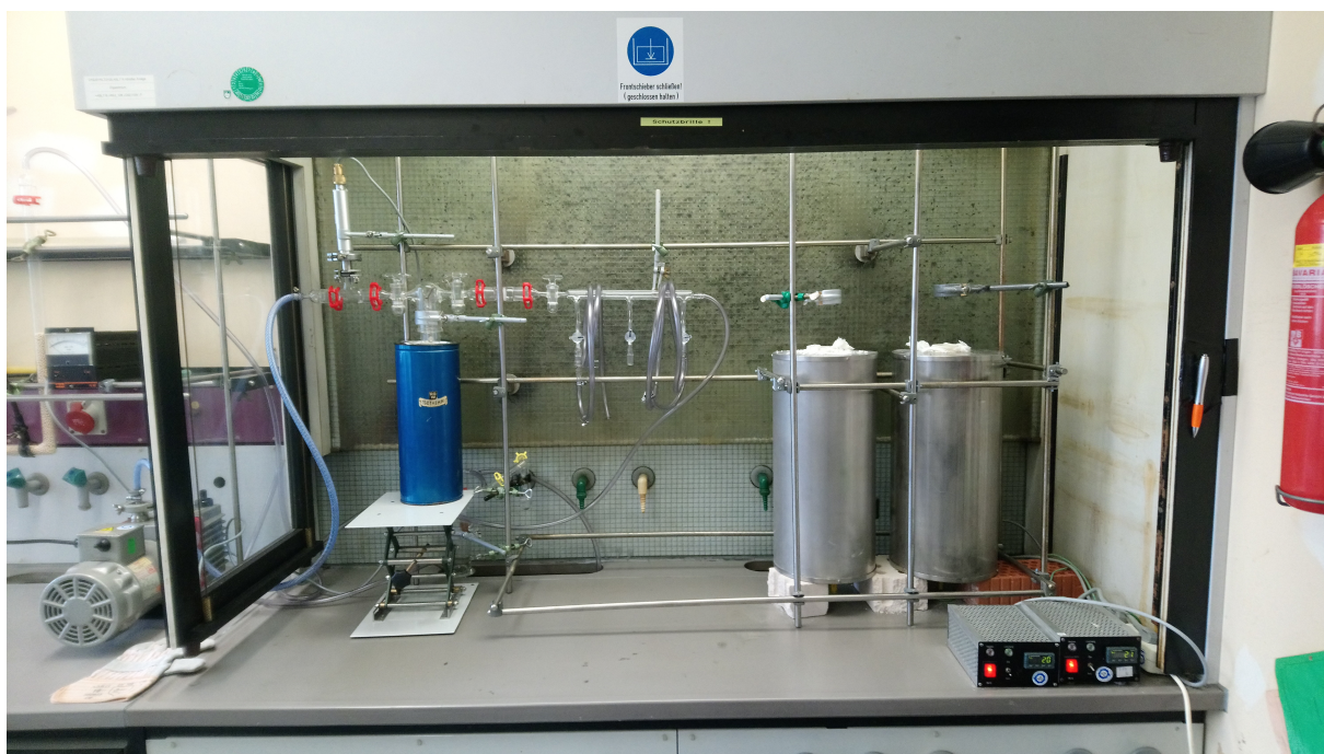
Abbildung 3.2 Abzug mit Syntheseaufbau zum Arbeiten unter statischer Stickstoffatmosphäre
