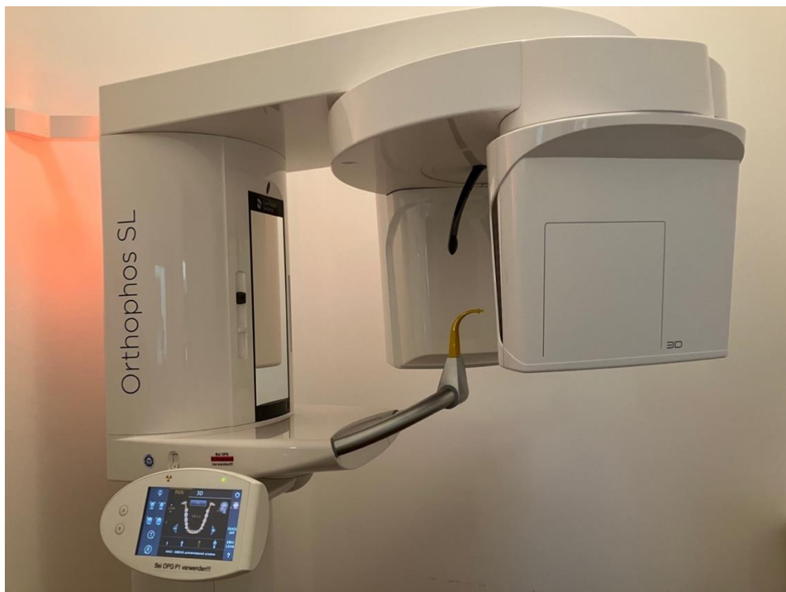
Abbildung 2: Beispiel eines Kombinationsgerätes für Panorama- und DVT-Aufnahmen mit stehender Patientenposition
