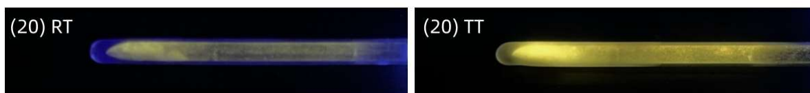
Abbildung 3.3.6-4 Lumineszenz von 20 bei Raum- (links) und Tieftemperatur (77 K, rechts).
