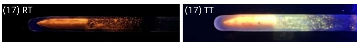
Abbildung 3.3.4-3 Lumineszenz von 17 bei Raum- (links) und Tieftemperatur (77 K, rechts).
