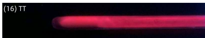
Abbildung 3.3.3-5 Lumineszenz der Verbindung 16 bei Tieftemperatur (77 K).
