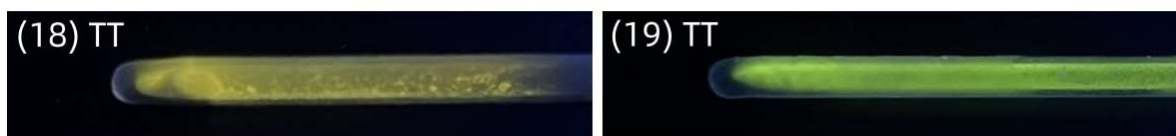
Abbildung 3.3.5-5 Lumineszenz von 18 (links) und 19 (rechts) bei Tieftemperatur (77 K).
