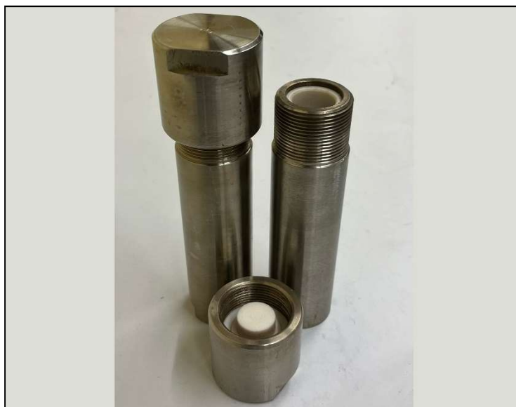
Abbildung 2.1.3-1 Für Solvothermalsynthese verwendeten Stahlautoklaven mit Teflonauskleidung.
