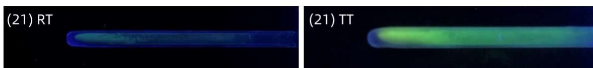
Abbildung 3.3.7-5 Lumineszenz von 21 bei Raum- (links) und Tieftemperatur (77 K, rechts).
