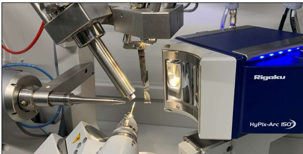
Abbildung 2.2.2-1 Aufbau eines Rigaku XtaLAB Synergy-R Diffraktometers.
