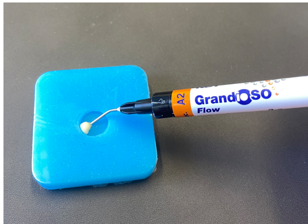
Abbildung 5: Silikonform für Probekörperherstellung
