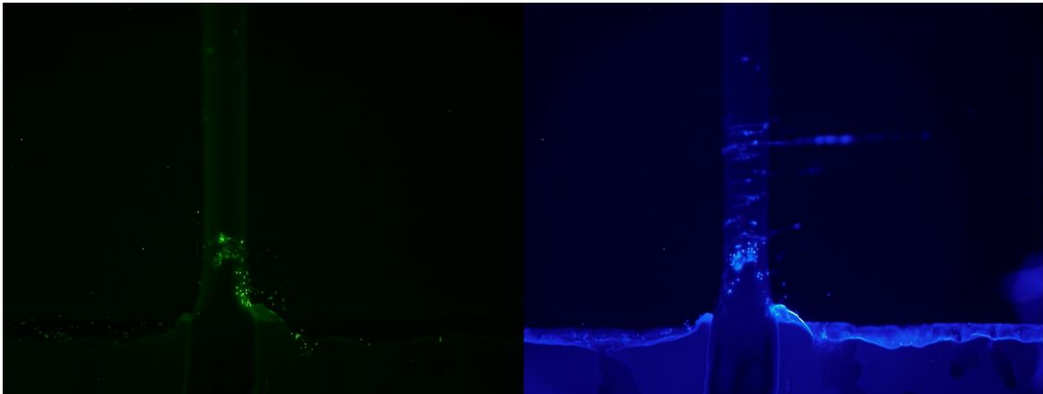
Abbildung 35: Belegung der Gasfaser am unteren Ende mit vitalen Zellen (grüne Punkte, Calcein, links) und DNA-Fäden/DNA-Ablagerungen (blaue Striche und Punkte, DAPI, rechts) bei der nach dem Versuch mit entionisiertem Wasser gespülten Strömungskammer.
