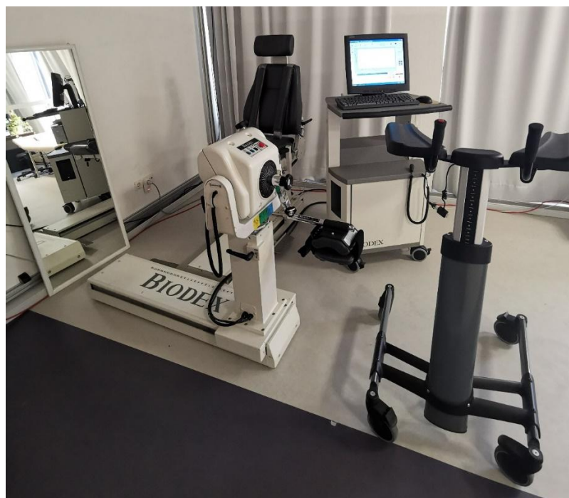
Abbildung 4.3 Versuchsaufbau zur Kraftmessung der rechten Hüfte am Biodex-Gerät
